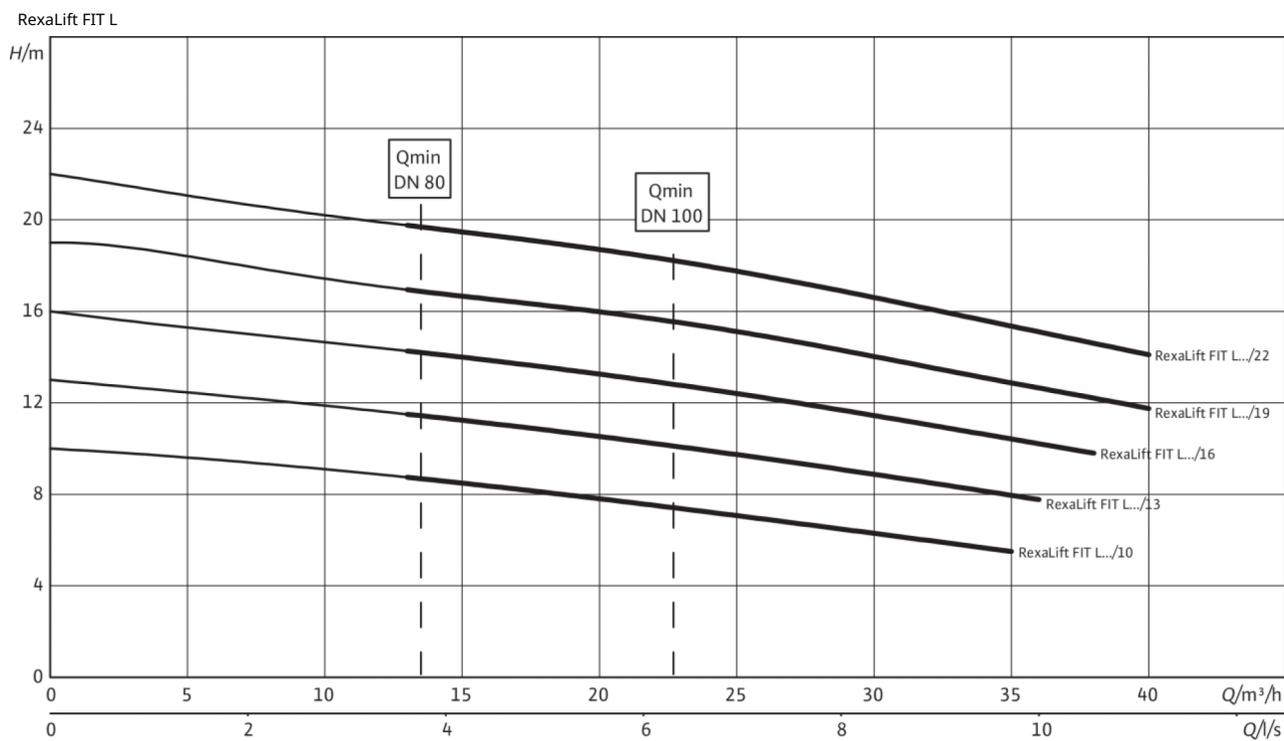
Согласно EN 12056-4,6.1 следует соблюдать скорость потока (в напорном трубопроводе) в диапазоне от 0,7 до 2,3 м/с. Показанные значения  $Q_{min}$  относятся к внутреннему диаметру стальных труб со стандартными стенками.
