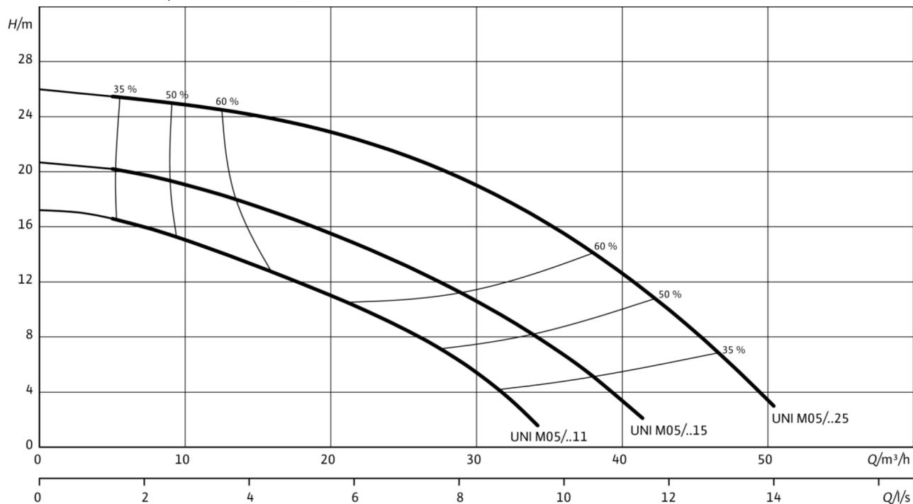
Указанные коэффициенты полезного действия соответствуют гидравлической эффективности.
