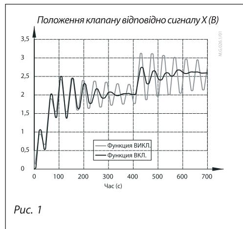
iMCV 2-го покоління – це оновлена серія інтелектуальних електроприводів від Danfoss. Гармонійні коливання це високочастотні коливання з малою амплітудою, які змінюються біля власного рівноважного значення, а не біля встановленого значення температури. Такі коливання можуть з'являтися протягом до 70 % контролюваного часу, навіть якщо система правильно експлуатується. Ці гармонійні коливання чинять негативний вплив на стабільність керування та на термін експлуатації клапану та приводу.
