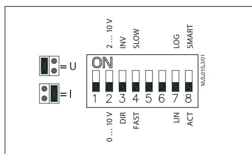
DIP-перемикач – це вісім мікроперемикачів (надалі – МП), включенням/виключенням яких може бути змінений функціонал електроприводу. За замовчанням, всі МП DIP-перемикача знаходяться в нижньому положенні, яке означає «OFF» (Виключений), але не позначено відповідним написом, на відміну від положення «ON» (Включений).
