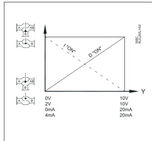
Електроприводи АМЕ... оснащені функціональним DIP-перемикачем, який розташований на електричній платі приладу під кришкою. DIP-перемикач – це дев'ять мікроперемикачів, включенням/виключенням яких може бути змінений функціонал електроприводу. Зокрема, якщо мікроперемикач (надалі – МП) за номером «6» буде встановлений у положення «ON» (Включений), електропривод буде керуватися імпульсним вхідним сигналом.
