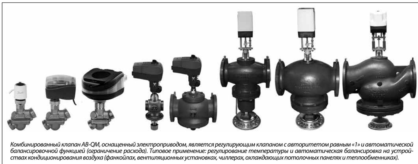
Комбинированный клапан АВ-QM, оснащенный электроприводом, является регулирующим клапаном с авторитетом равным «1» и автоматической балансировочной функцией (ограничение расхода). Типовое применение: регулирование температуры и автоматическая балансировка на устройствах кондиционирования воздуха (фанкойлах, вентиляционных установках, чиллерах, охлаждающих потолочных панелях и теплообменниках).
