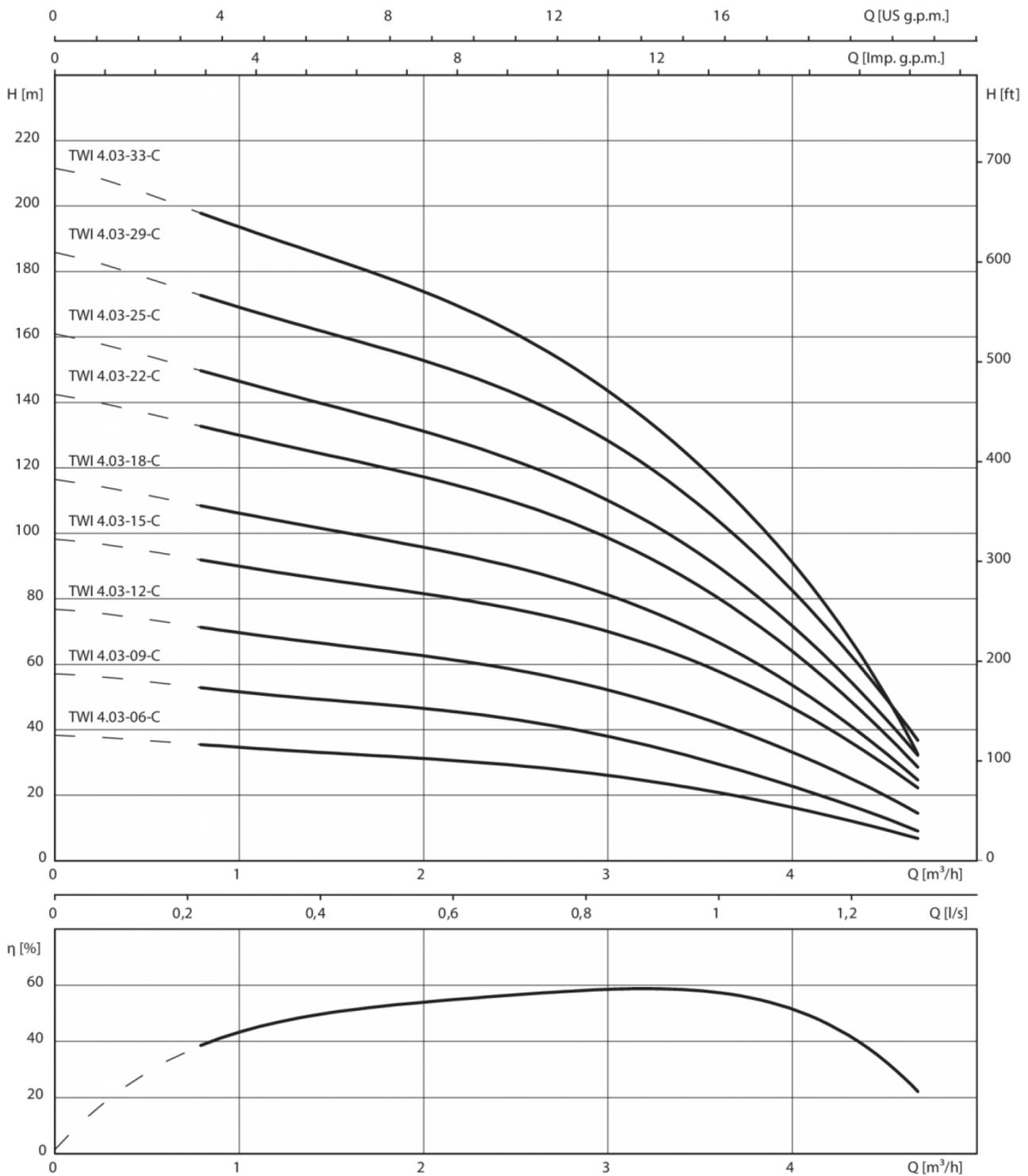
1~230 V, 50 Гц,  $\rho = 1 \text{ кг/дм}^3$ ,  $\nu = 1 \times 10^{-6} \text{ м}^2/\text{с}$ , ISO 9906 приложение А,  $\eta = \text{КПД насоса}$
