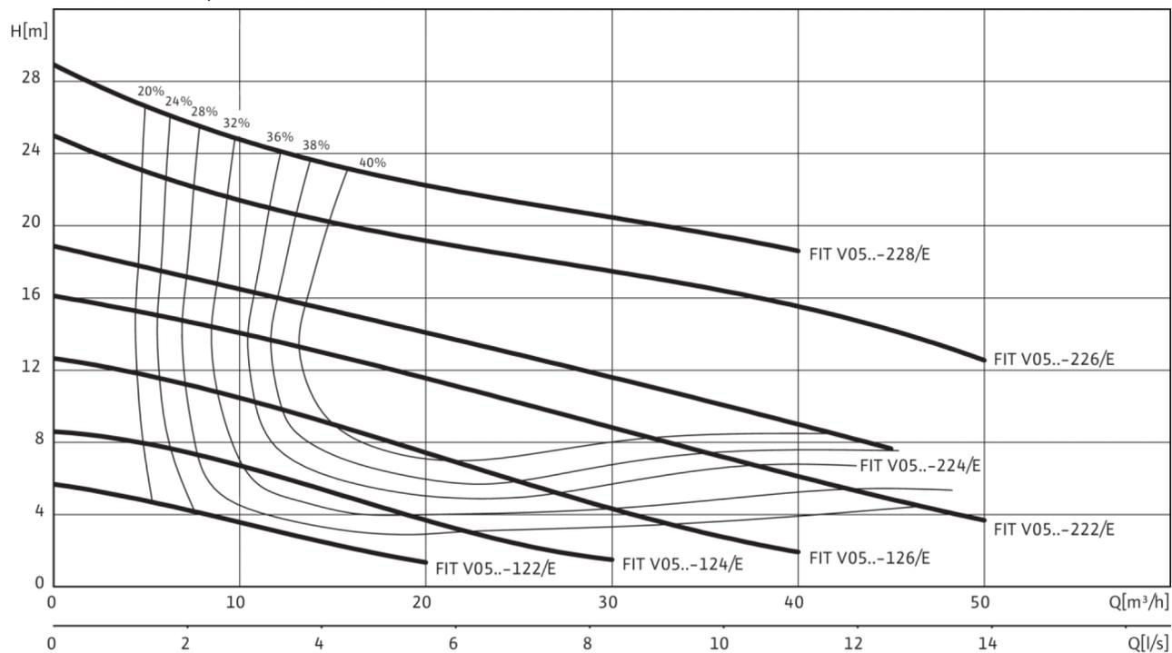
Характеристики насоса соответствуют ISO 9906, класс 3B, раздел 4.2.2. Указанные коэффициенты полезного действия соответствуют гидравлической эффективности.
