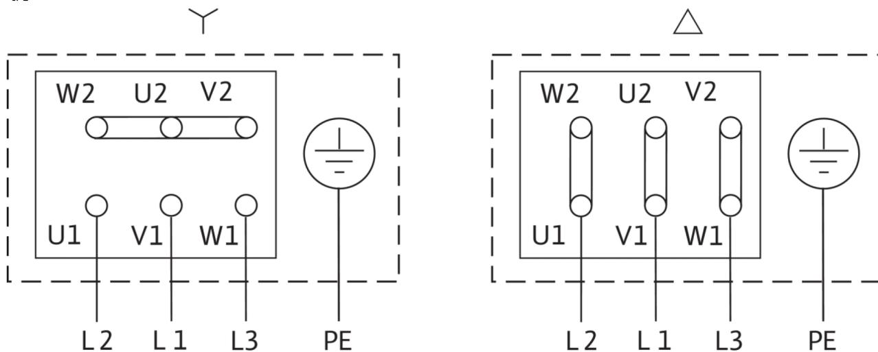
Δ: Схема соединения - треугольник
