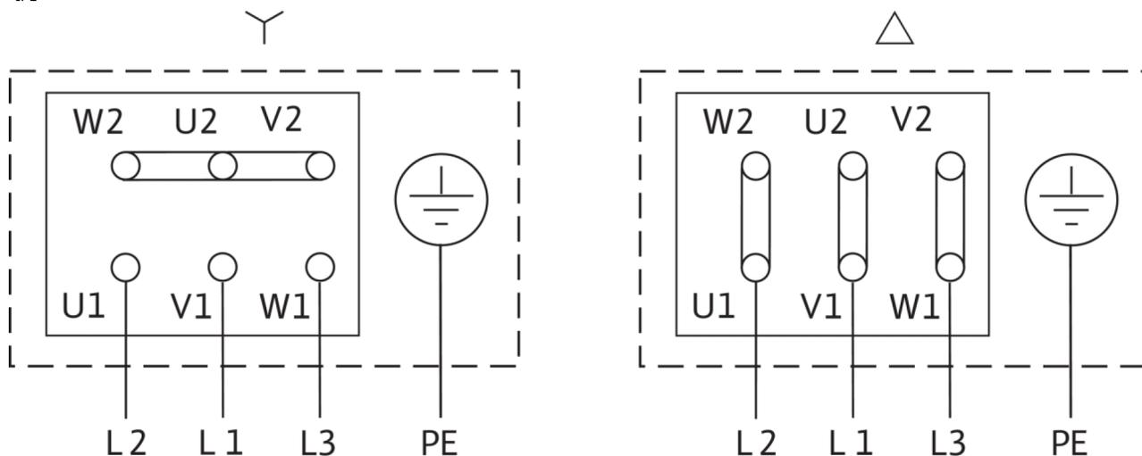
Δ: Схема соединения - треугольник
