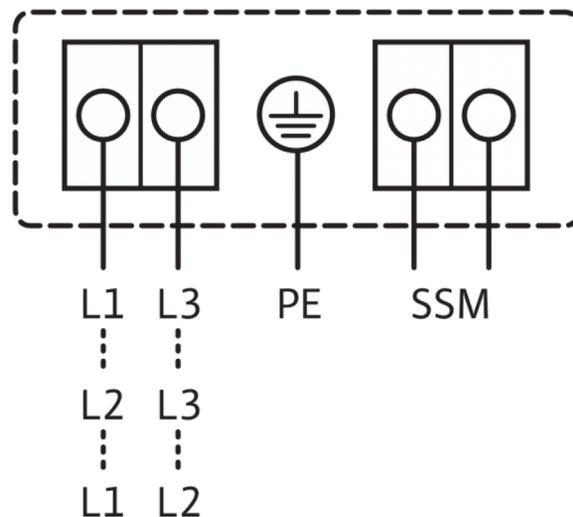
Обобщенная сигнализация неисправности
