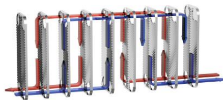
двоходовий система каналів, розділених на дві послідовно з'єднані групи
