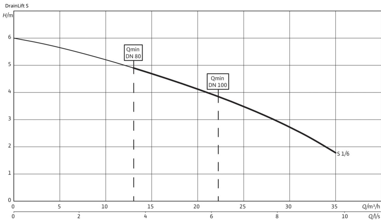
Согласно EN 12056-4,6.1 следует соблюдать скорость потока (напорном трубопроводе) в диапазоне от 0,7 до 2,3 м/с. Показанные значения  $Q_{мин}$  относятся к внутреннему диаметру нормальностенных стальных труб.
